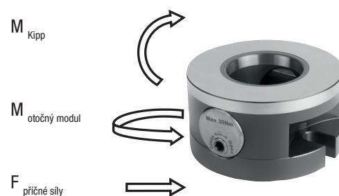
\* Do hodnoty příčné síly 3.000 N je správná funkce upínacích modulů, zejména opakovatelnost je zaručena. Až do kritické příčné síly 20.000 N je zaručeno zabezpečení vůči selhání a osobní bezpečnost upínacích modulů.
